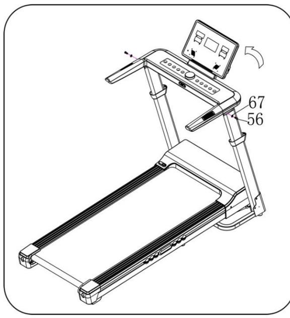
1. С помощью шестигранного ключа (10), шестигранного винта (56) и стопорной шайбы (67) зафиксируйте консоль на вертикальной стойке с левой и правой стороны.
